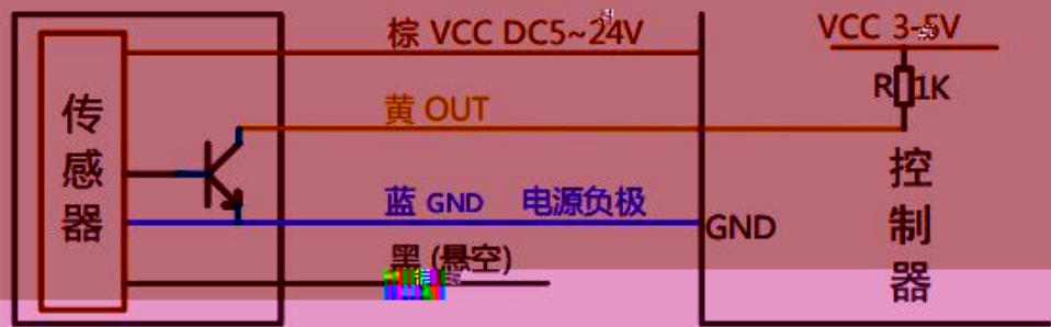
NPN信号输出：连接控制器或MCU的接线方法
